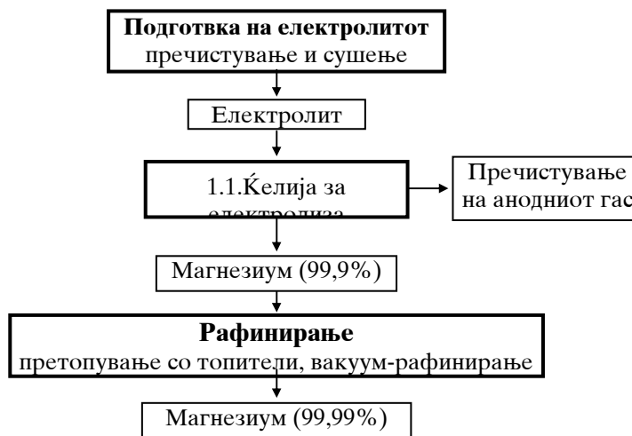
Слика 16-1. Технолошка шема за електродобивање магнезиум
