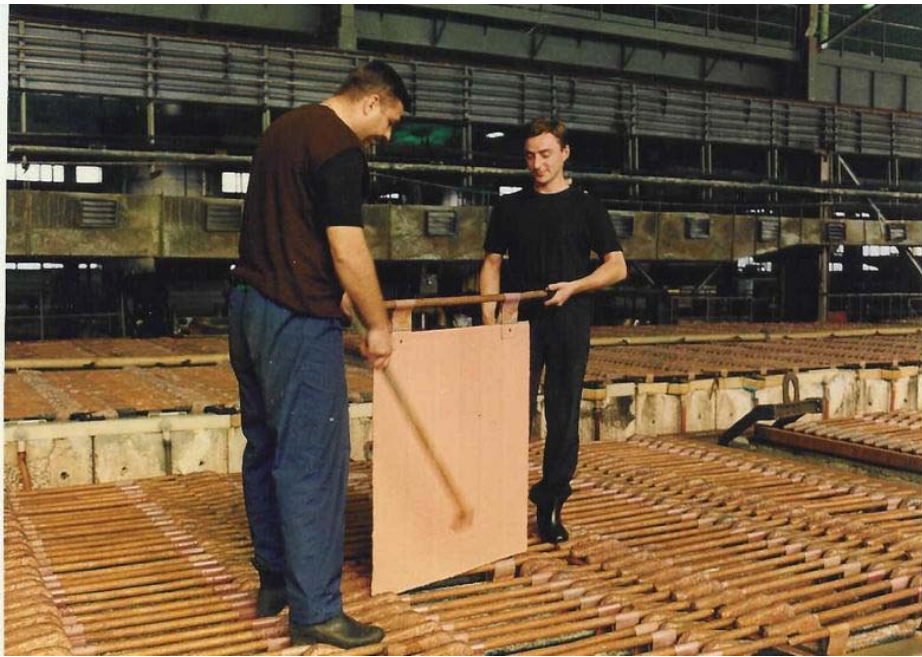
Електрорафинирање на бакарот: Целиот под е пополнет со ќелии за електролиза со густо пакувани катоди и аноди
