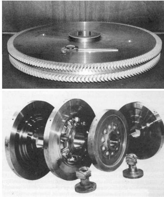
Слика 19-1. Метални делови изработени со електропрофилирање
