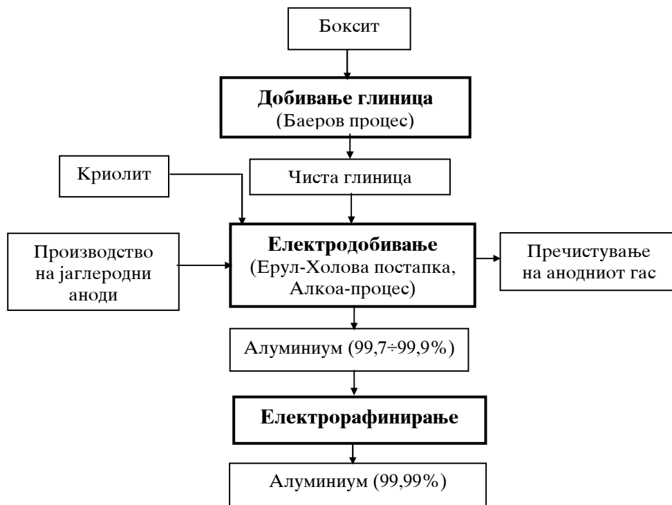
Слика 15-1. Технолошка шема за добивање високочист алуминиум по пат на електролиза
