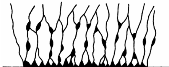
Слика 6-8. Шематски приказ на катодниот депозит и на празнините во него исполнети со електролит
