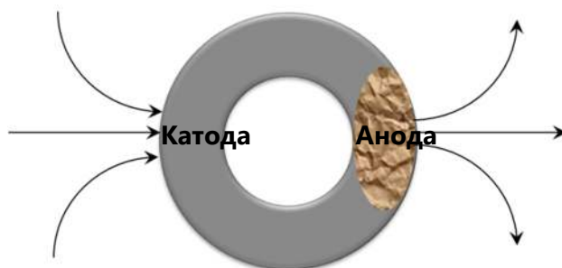
Слика 9-3 Корозија со талкачки струи на едноставен метален објект
