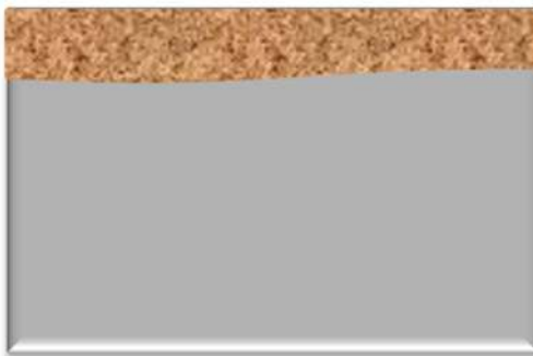
Слика 6-2 Шематски приказ на општ корозивен напад врз целата метална површина
