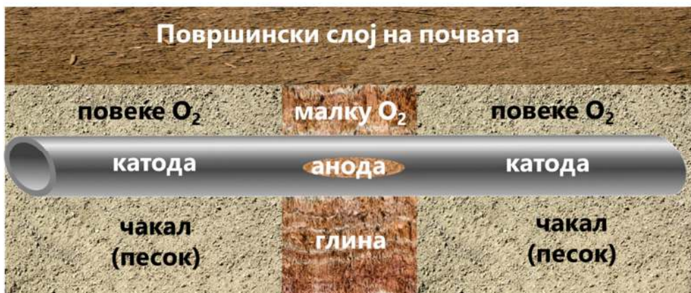
Слика 9-1 Диференцијално-аерациона ќелија врз цевка во почва со различна порозност (порозен чакал и слабо порозна глина)
