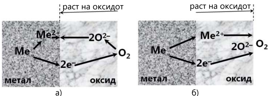
Слика 6-10 Механизам на оксидирање на металите во сува средина преку оксиден филм
