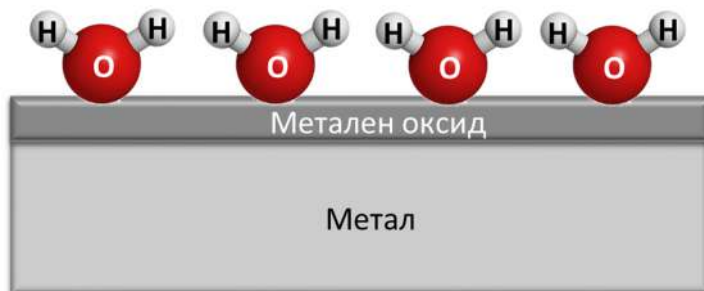
Слика 8-2 Атсорпција на вода врз метална површина
