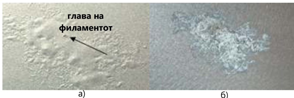
Слика 6-7 Кончеста корозија (создавање филаменти) кај превлечен алуминиум: а) пред и б) по симнување на превлеката
