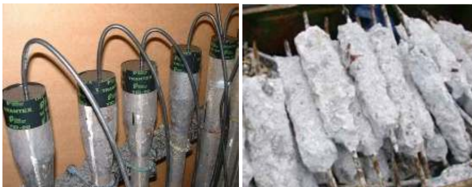
Слика 14-2 Аноди од сиво леано жезезо: а) неупотребени, со залиени кабли за поврзување во системот за КЗ и б) по употреба
