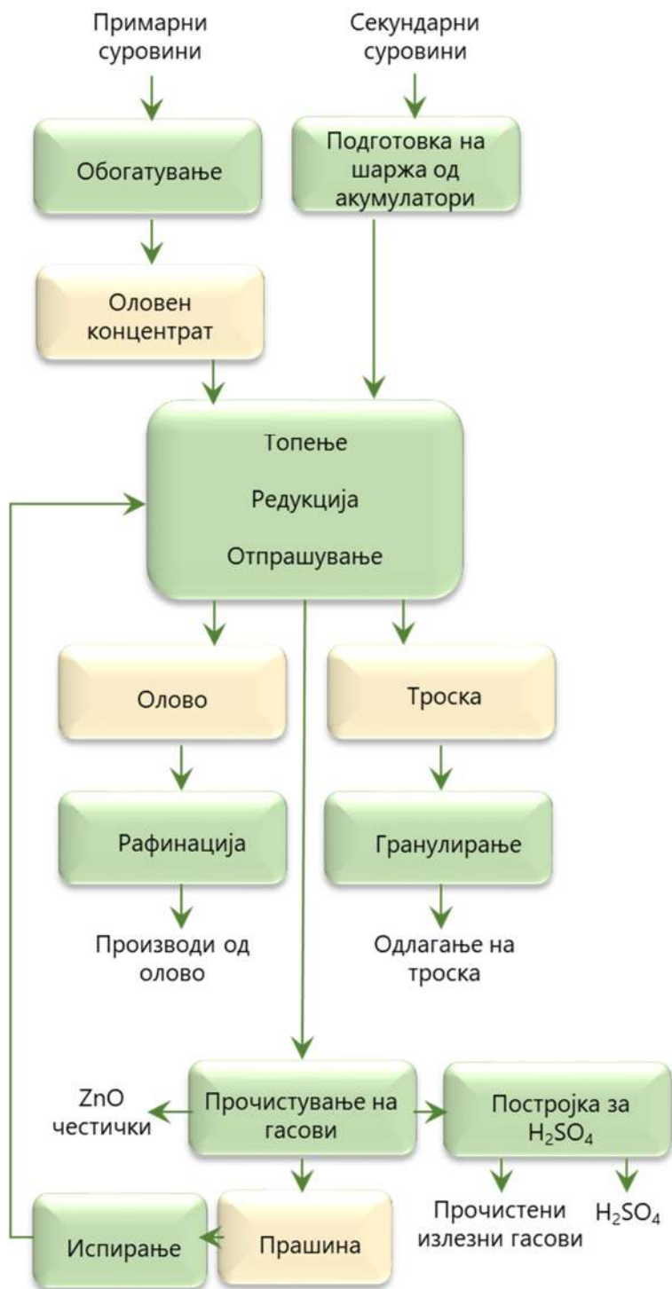
Слика 2-16 Технолошка шема на Оутотек Аусмелт постапка
