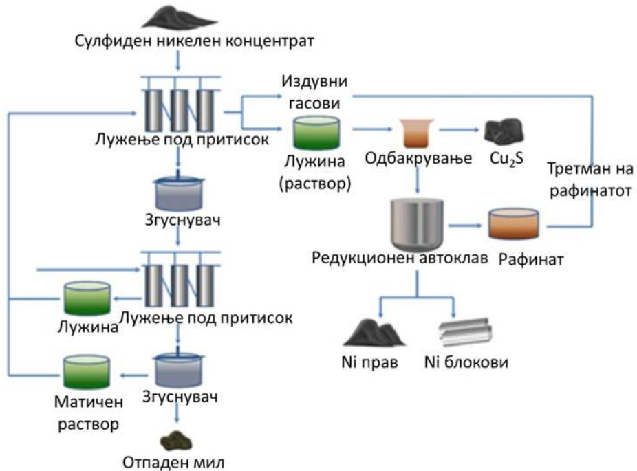
Слика 4-6 Шема на амонијачно лужење под притисок
