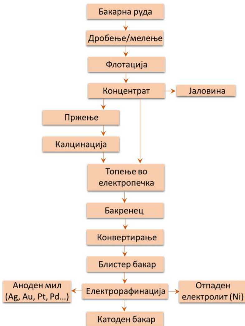
Слика 1-2 Технолошка шема за пирометалуршко добивање бакар
