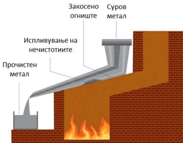
Слика 2-7 Шематски приказ на ликвација при рафинација на олово
