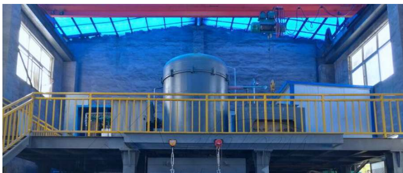
Слика 2-9 Котел за одвојување на сребро и злато по Паркесова постапка
