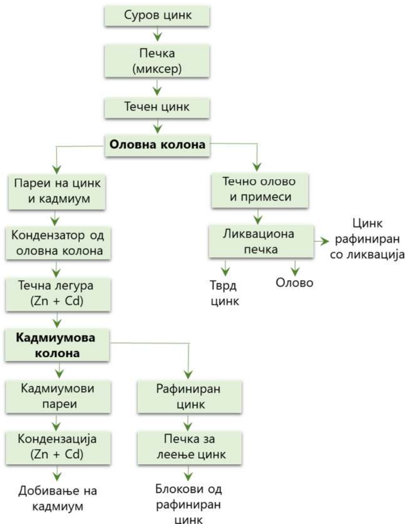
Слика 3-6 Технолошка шема на процесот на рафинација на суров цинк
