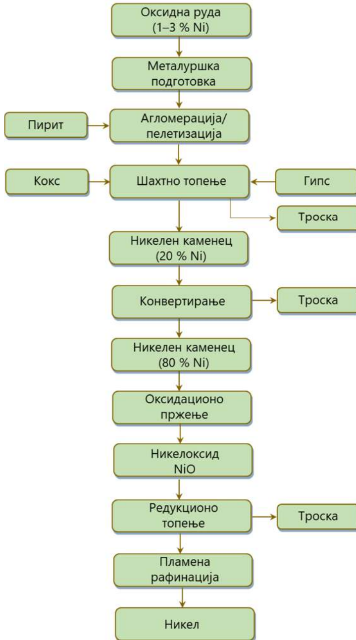
Слика 4-4 Технолошка шема за добивање никел од оксидни руди
