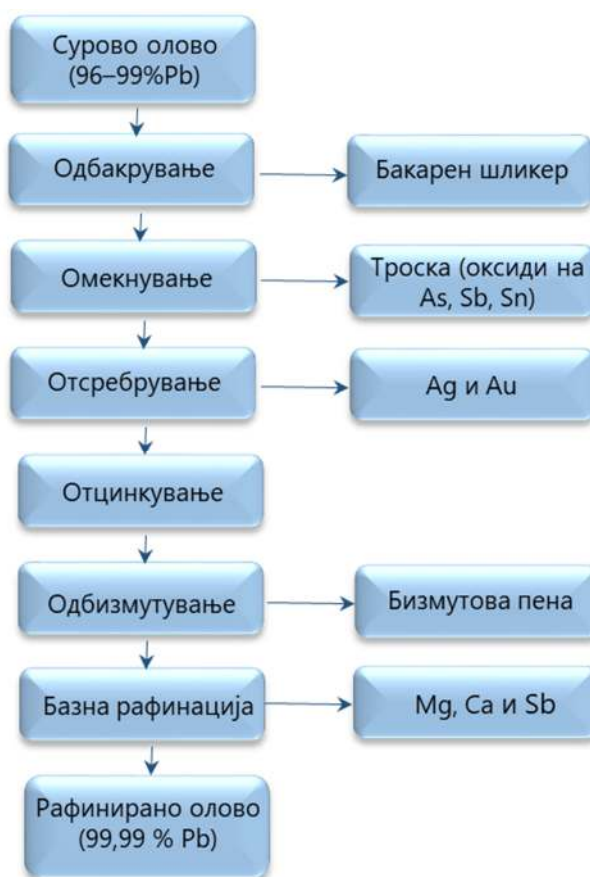
Слика 2-6 Технолошка шема на пламена рафинација на олово
