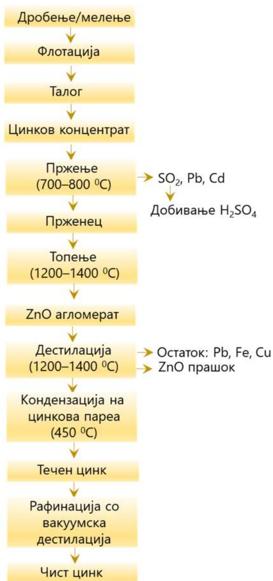
Слика 3-2 Технолошка шема за пирометалуршко добивање цинк
