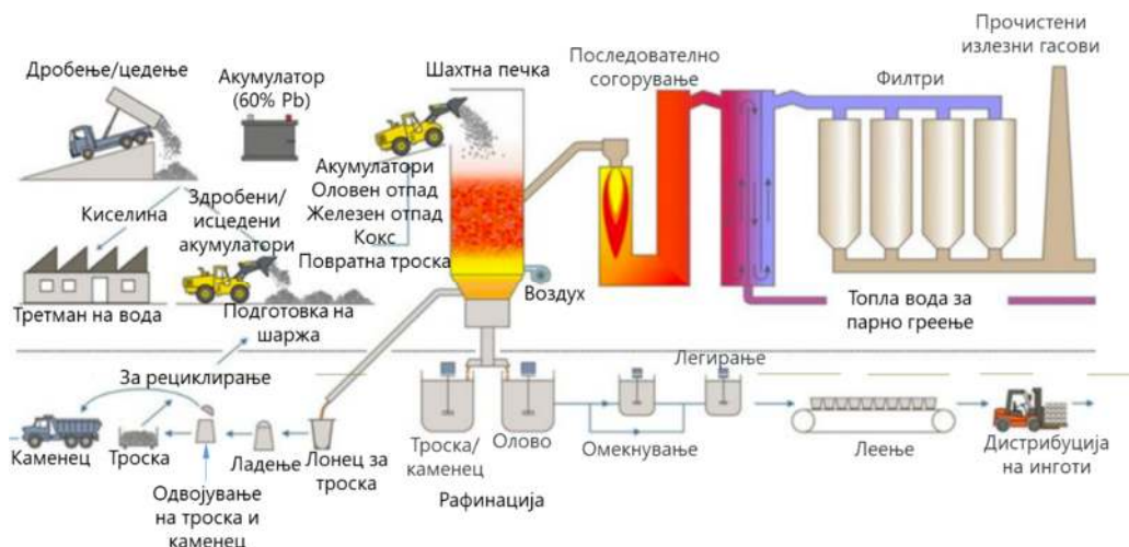
Слика 2-23 Болиден Бергосуе процес за производство на олово без предтретман на отпадните оловни сировини
