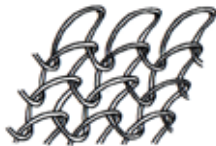
Слика 11.6. Спирална деформација на котелците под дејство на торзиони сили во преѓата
