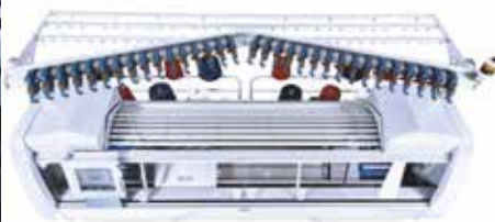
Слика 8.4. Директно додавање на преѓа, а) водач со отворена санка, б) положба на затегнувачите
