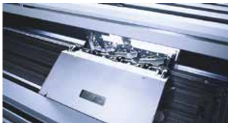
Слика 8.4. Директно додавање на преѓа, а) водач со отворена санка, б) положба на затегнувачите
