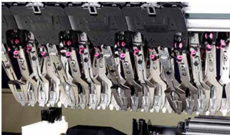
Слика 9.1. Положувачи на преѓа кај интарзија
