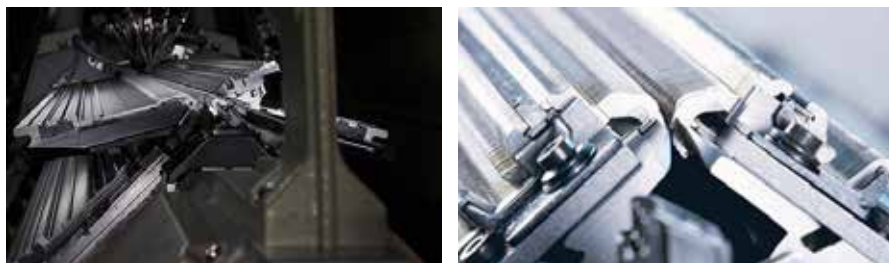
а) Машина со четири игленици за обликување и дезенирање, б) дополнителни платини
