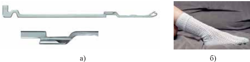
Слика 10.8. Трансфер на котелци а) игла за трансфер на котелци на кружна игленица, б) дезен на плетенината
