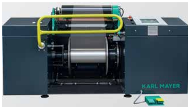
Слика 12.1. Сновалка за секциско сновење
