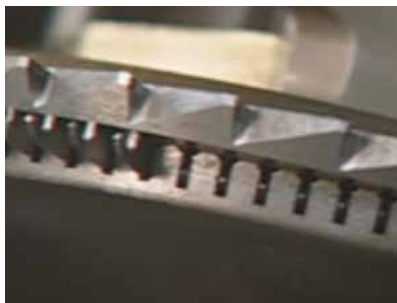
Слика 10.5. Диск игленица со помошни платини и ножеви
