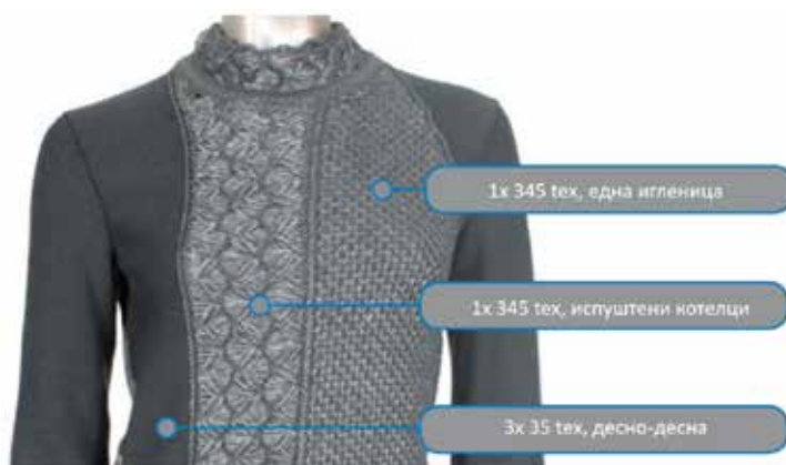
Слика 9.11. Различна густина на котелците во редот
