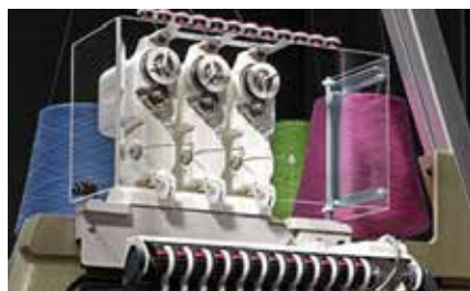
Слика 8.6 а) Странично поставен механизам за додавање со фрикциони тркалца, б) активно додавање на преѓа на i-DSCS+DTC системот на „Shima“
