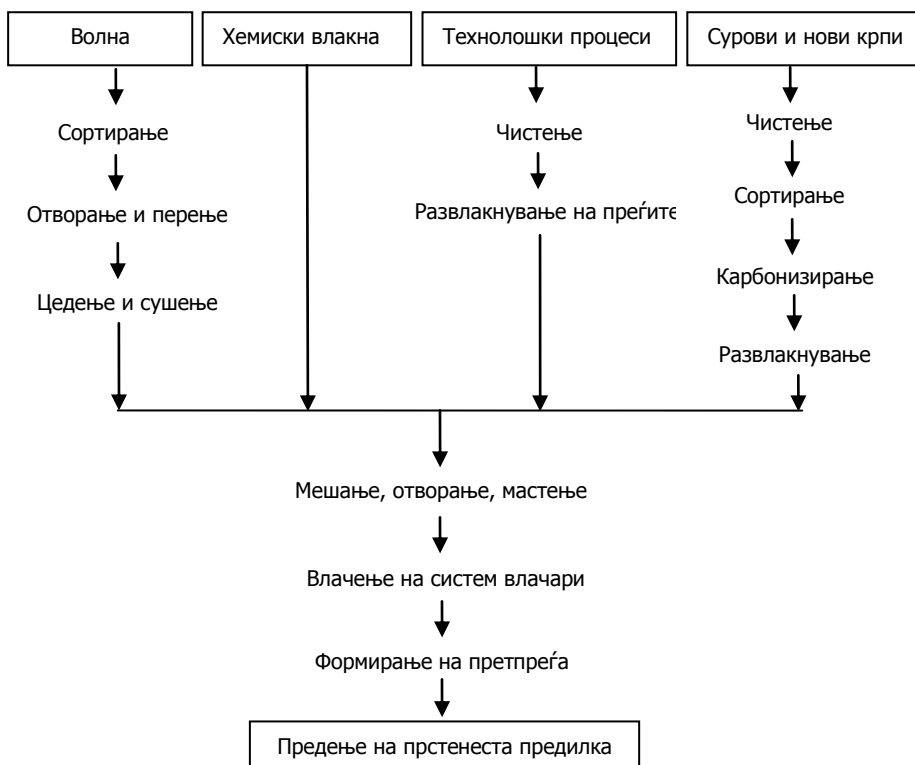
Слика 45. Преработка на волнените влакна по системот за влачење
