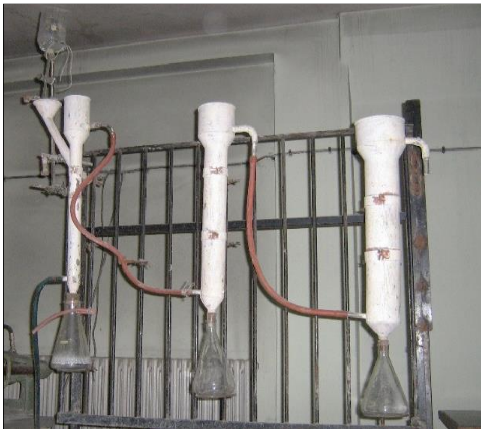
Слика 54. Лабораториска постројка за противструјно класирање (елутрација)
