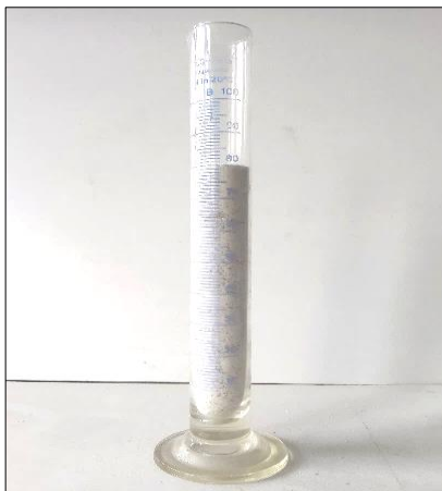
Слика 17. Определување насипна маса
