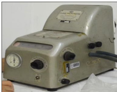
Слика 28. Пламен фотометар тип Evans Electroselenium Ltd.
