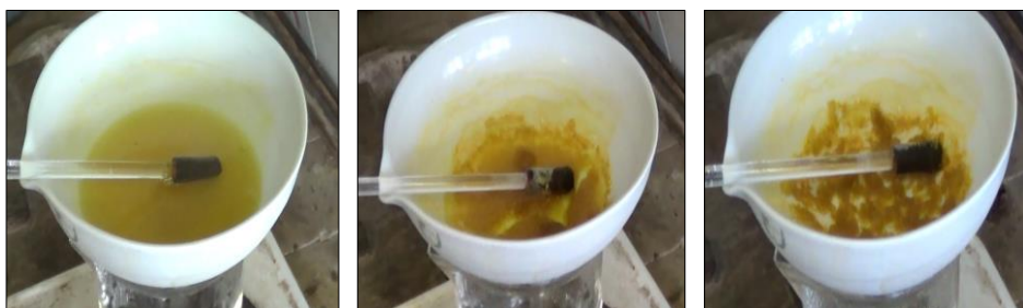
Слика 26. Создавање \text{SiO}_2 хидрогел
