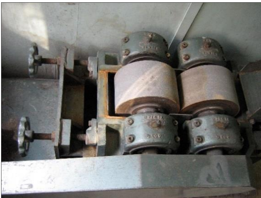
Слика 48. Дробилка со валци тип DENVER B7141A
