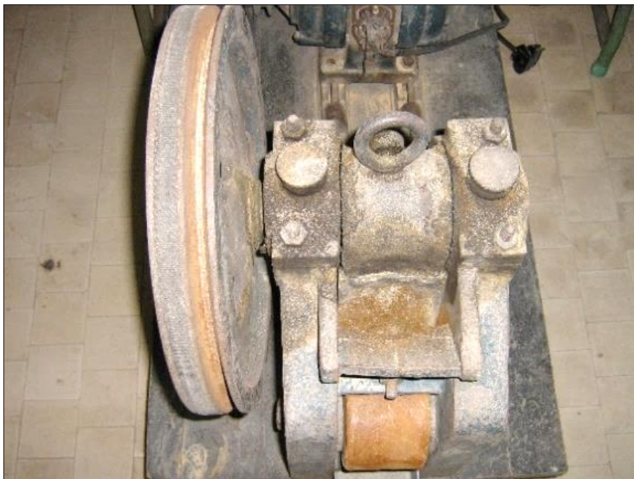
Слика 47. Челусна дробилка тип BLAKE
