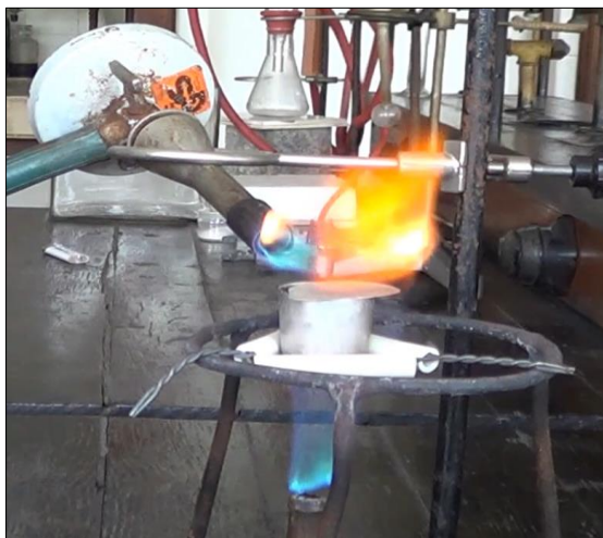
Слика 25. Топење на пробата за анализа
