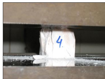
Слика 20. Пробно тело и раздробено пробно тело
