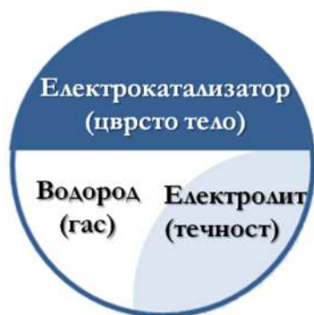
Слика 15 Трофазна граница (гас–течност–цврсто тело) во гас-дифузиона електрода (GDE)
