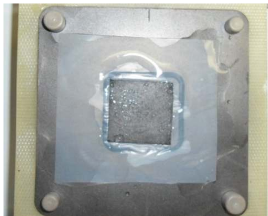
Слика 48 Мембрански електроден склоп (МЕА) за реакцијата на редукција на кислород (ORR)
