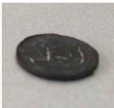
Слика 16 Напечен пресек и реален изглед на трофазна гас-дифузиона електрода (GDE)
